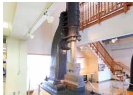
スチームハンマー (旧横須賀製鉄所設置) 1865年オランダ製0.5トン片持型
