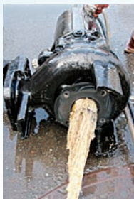
▲タオルが詰まったポンプ
