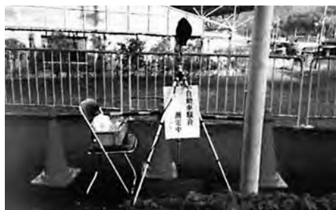
騒音測定の様子
