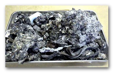
混入して困る焼却不適物は上記の鉄製品以外にもたくさんあります。この写真はガラスや金属が溶けて石のように固まったものです。ガラスが飴のように溶けて焼却炉内の耐熱レンガに付着すると、炉を止めて冷えた時にレンガの表面ごと崩れ落ちてしまい、焼却炉の寿命を縮めてしまいます。
