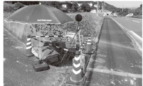
騒音測定の様子
