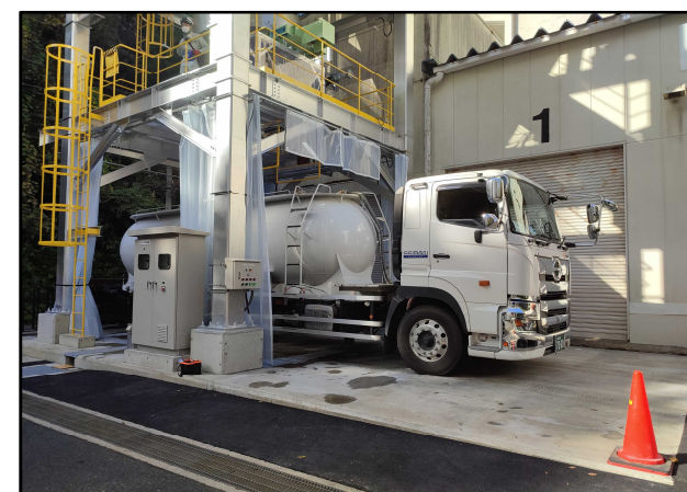
ジェットパック車による飛灰の搬出・輸送
