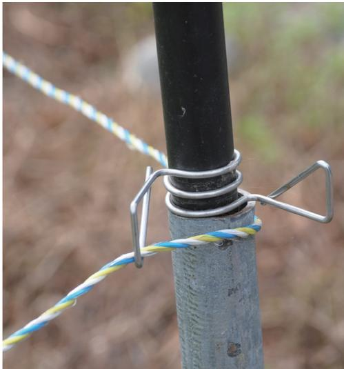
▲電柵の支柱を受ける鉄パイプに柵線が触れて漏電していた例。このとき、支柱の前後で電圧が大きく低下しており、近くを調べた結果漏電が見つかりました。電圧チェッカーを用いることで、問題か所を見つけやすくなります。
