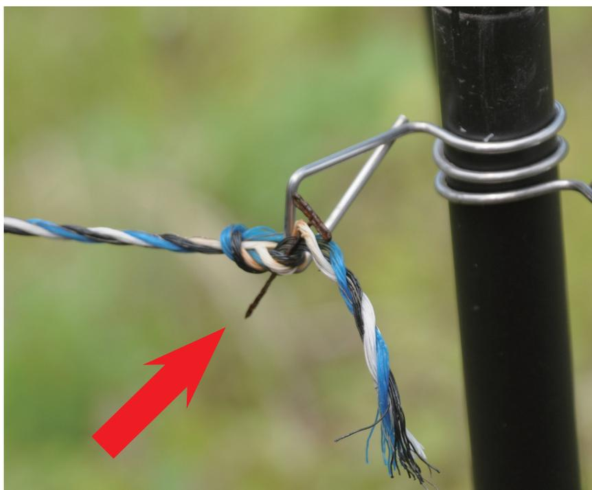
▶小さな針金が柵線に刺さって漏電してしまっている。電気を通す金属類と触れていないか注意してください。
