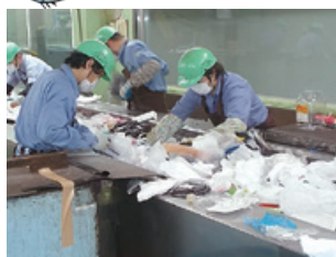
▲手作業で分別している状況
