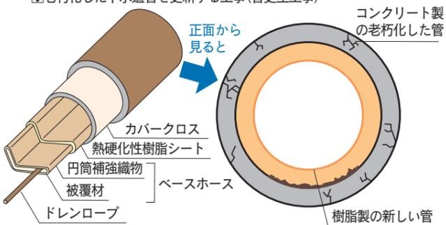
▲古くなった下水道管の中に風船のチューブのような素材を入れて内面を補強し、新しい管として再利用します。
