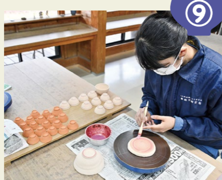
約800度で素焼きする。その後、置くときに接地する面には水剤を塗る。
