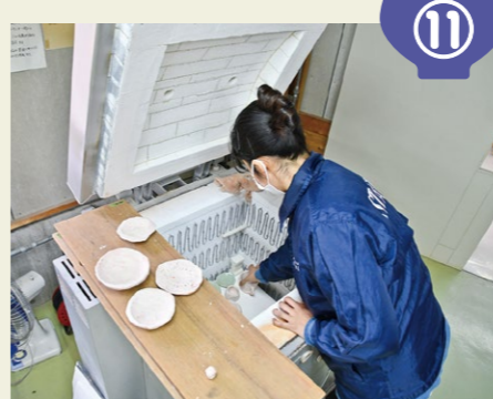
約1,230度で本焼きし、釉薬を溶かしてガラス化させる。ここで色が出る。
