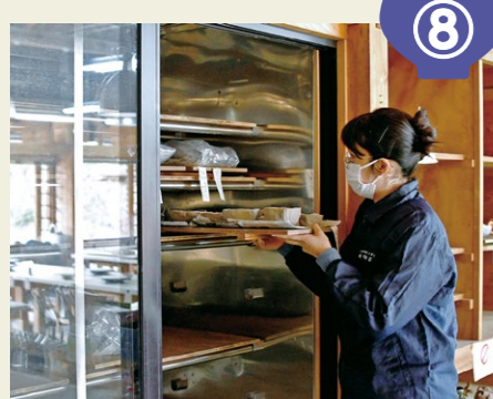
むろ室と呼ばれる湿度の高い保管庫で時間をかけて乾かし、大体乾けば外に出し乾かす。
