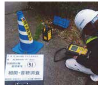
▲相関式漏水探知機を使った漏水調査
