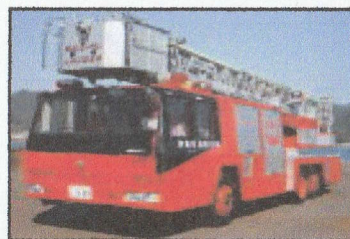
梯子付消防ポンプ車 (30m 級)
